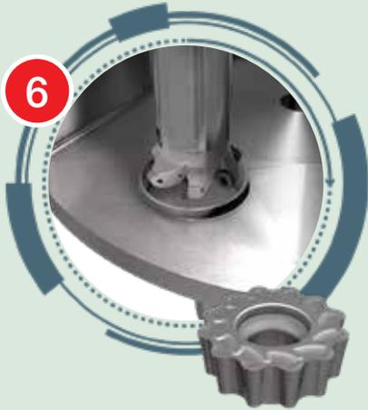
**Interpolación Helicoidal de Desbaste**
